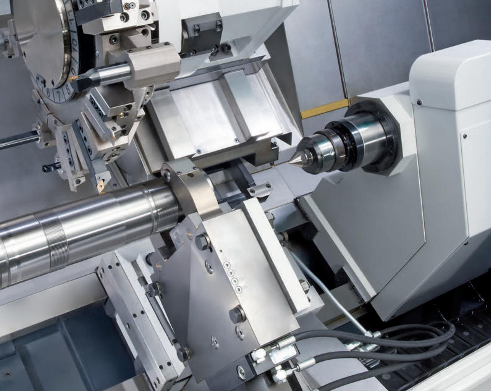
Il modello B1250 ha in comune con il B750 la torretta ed i carri X/Y. La versione B1250, pensata per la lavorazione di alberi, è caratterizzata da 1310 mm di corsa longitudinale, da una robusta contropunta programmabile con canotto idraulico diametro 115 mm e dalla possibilità di montare una lunetta automatica "a seguire" con movimento indipendente azionato da un motore asse.
